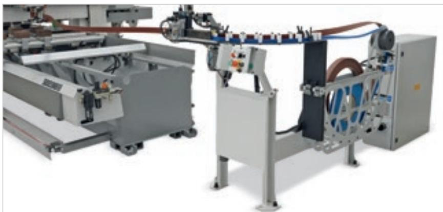
Cambio rapido delle bobine con magazzino bordi posizionato fuori dalla reti di protezione.
