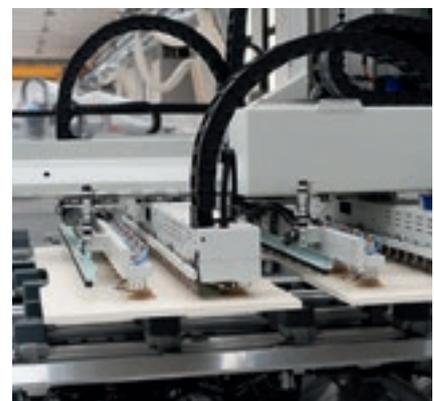
Sono disponibili due tipologie di **lettrici codice a barre** per la lettura dei bar code sia sulla faccia superiore che sulla faccia laterale del pannello tramite i quali è possibile caricare in distinta il programma di lavorazione corretto evitando errori da parte dell'operatore.
