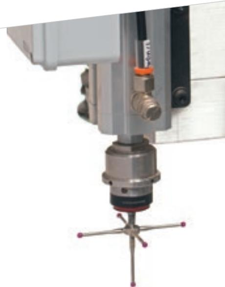
Il **tastatore a croce** consente di rilevare con la massima precisione le dimensioni del pannello.
