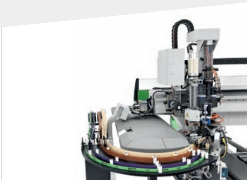
Il **magazzino** per l'alimentazione automatica dei bordi, montato su carro X, permette di utilizzare bordi sottili o di spessore durante lo stesso ciclo di lavoro.
