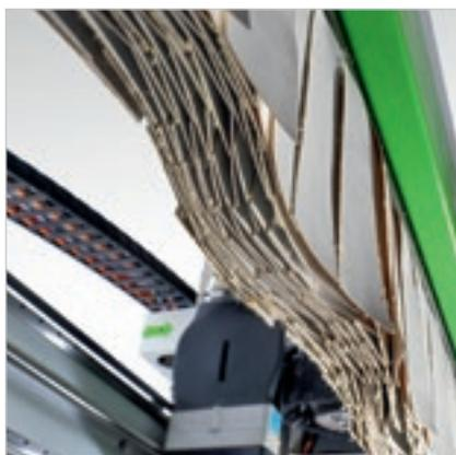
**Bandelle laterali** a protezione del gruppo operatore, mobili per lavorare a massima velocità in totale sicurezza.
